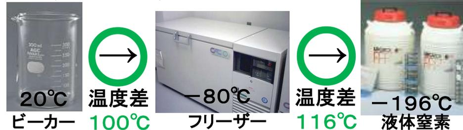
※この場合、温度差が216℃なので、直接入れると破損する可能性が高い。一度フリーザーで、ビーカーを冷やしてから液体窒素を注ぐと破損しづらくなる。
