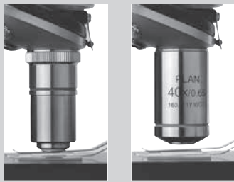
一般的な対物レンズ (作動距離 0.5mm)
